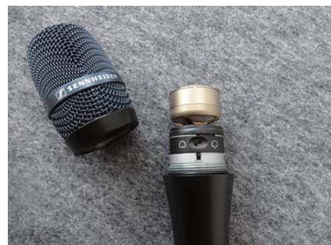
写真2 SENNHEISER e 965は単一指向性/スーパーカーディオイドの切り替えができます
