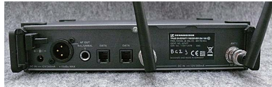
写真4 受信機の背面部。XLRとフォンと、アウトプットは2つの端子を搭載
