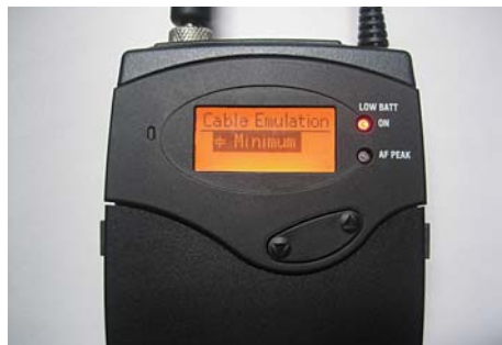
写真2 ケーブルのサウンド変化を再現する、ケーブル・エミュレーション機能
