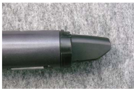
写真3 ハンドヘルド送信機SKM 100-835 G3 (価格：5万4,600円)のシャークフィン・アンテナ
